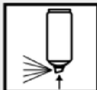
6. Очистите распылительную насадку. Для этого переверните баллон и удерживайте нажатой насадку до тех пор, пока из сопла не начнет выходить один газ без продукта.
