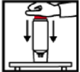
3. Поместите баллон на ровную горизонтальную поверхность и надавите на клапан с достаточным усилием для активации продукта.
