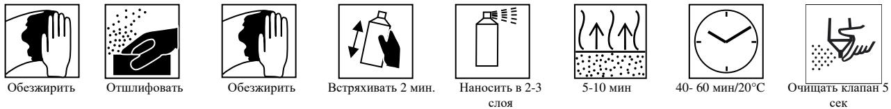
**CAVITY WAX - ПРЕПАРАТ ДЛЯ ЗАЩИТЫ ЗАКРЫТЫХ ПРОФИЛЕЙ** – средство по уходу, прекрасно защищающее от коррозии. Устойчив к влиянию атмосферных факторов, слабых щелочей и кислот. Обладает прекрасными свойствами проникания вглубь щелей, образует эластичное, плотное покрытие, предохраняя от действия воды и соли. Характеризуется способностью устранять сырость из основания. Допустимые VOC II/B/e = 840 г/л, VOC < 570 г/л.
