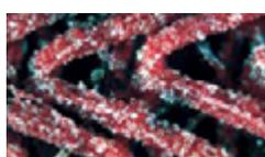
Зерна абразивного минерала на тканевой основе
