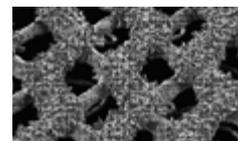
Структура полиамидной сетки с нанесенным абразивом
