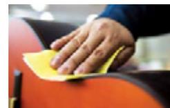
Применяется для шлифовки сложных контуров и углов.
